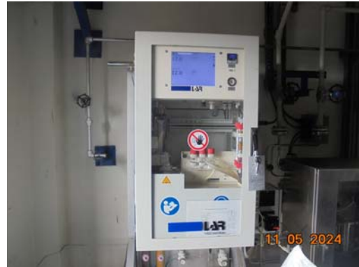
รูปที่ 3.21 ระบบตรวจวัดค่า COD แบบอัตโนมัติ
